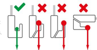
Le poids maximum de charge pour un crochet n'est valable que si le cadre est correctement fixé au crochet. Le schéma ci-joint montre les modalités appropriées concernant les charges.
